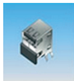
Рис. 7. Аппаратный имплант COTTONMOUTH-II
