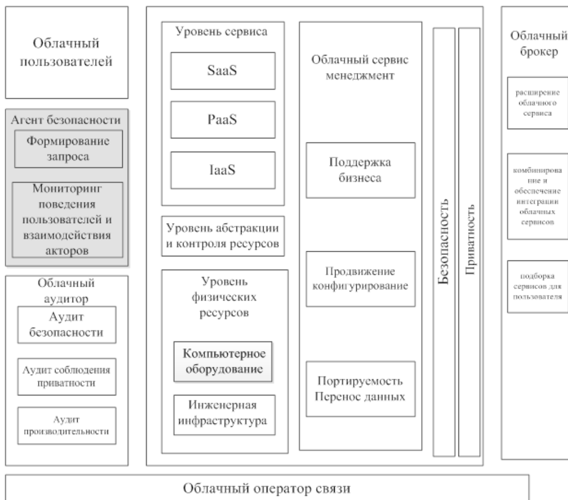
Рис. 8. Концептуальная структура взаимодействия акторов системы облачных вычислений
