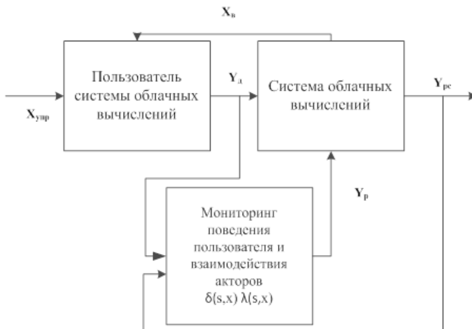
Рис. 9. Структурная схема взаимодействия облачного пользователя и системы облачных вычислений
