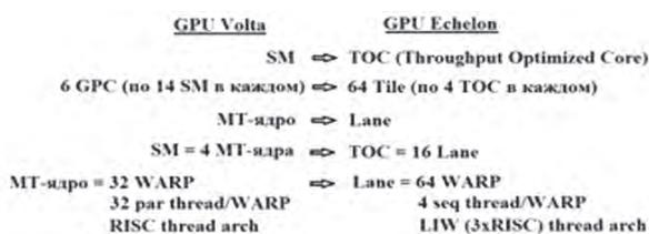
В показанной на схеме трансформации архитектур виден отказ от принципа SIMD в MT-ядре. Это ядро теперь называется Lane и в нем теперь 64 асинхронных треда (WARP-а), причем каждый такой WARP может управлять лишь последовательным выполнением до четырех тредов. Команда одного WARP-а теперь содержит
