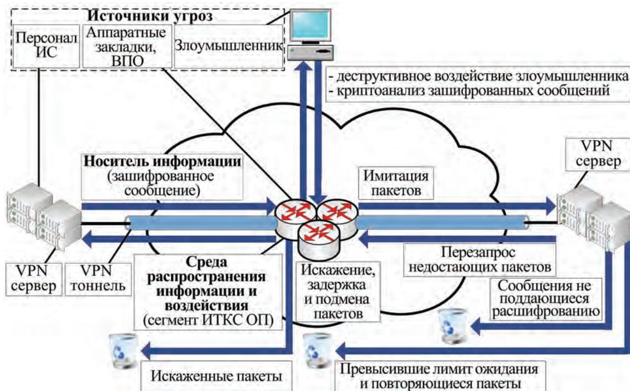
Рис. 3. Основные элементы каналов реализации угроз безопасности информации VPN
