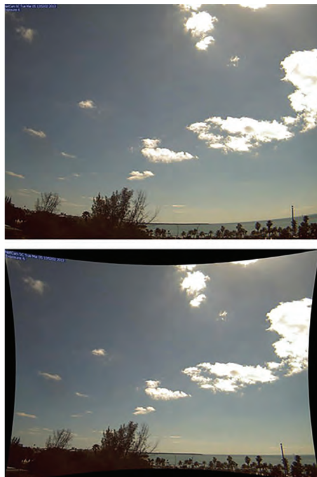
Рис.4. Пример радиальных искажений
