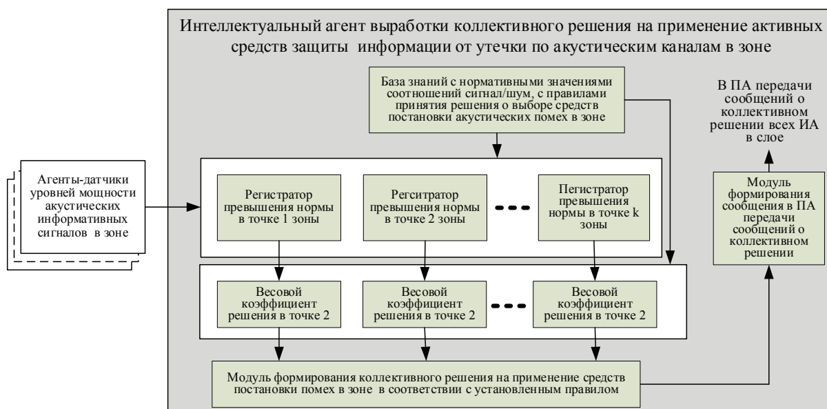
Рис. 3. Пример структуры интеллектуального агента, предназначенного для выработки коллективного решения на применение активных средств защиты информации от утечки по акустическим каналам в зоне
