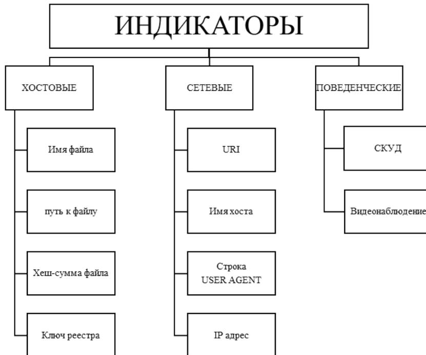
Рис. 1. Предлагаемая классификация внутренних источников индикаторов компрометации
