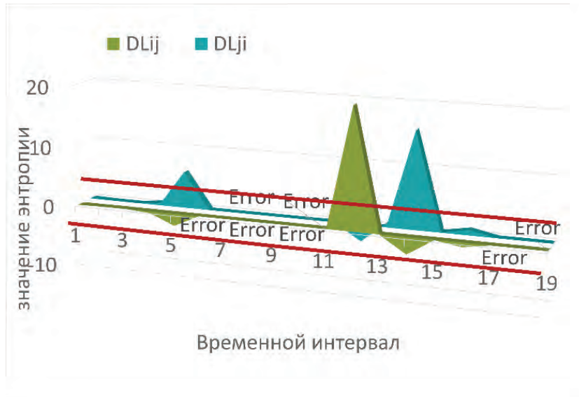
Рис. 13. Результат расчета энтропии для принятых пакетов узлом i относительно узла j (отмечен зеленым) и узлом j относительно узла i (отмечен синим) в условиях атаки деаутентификации
