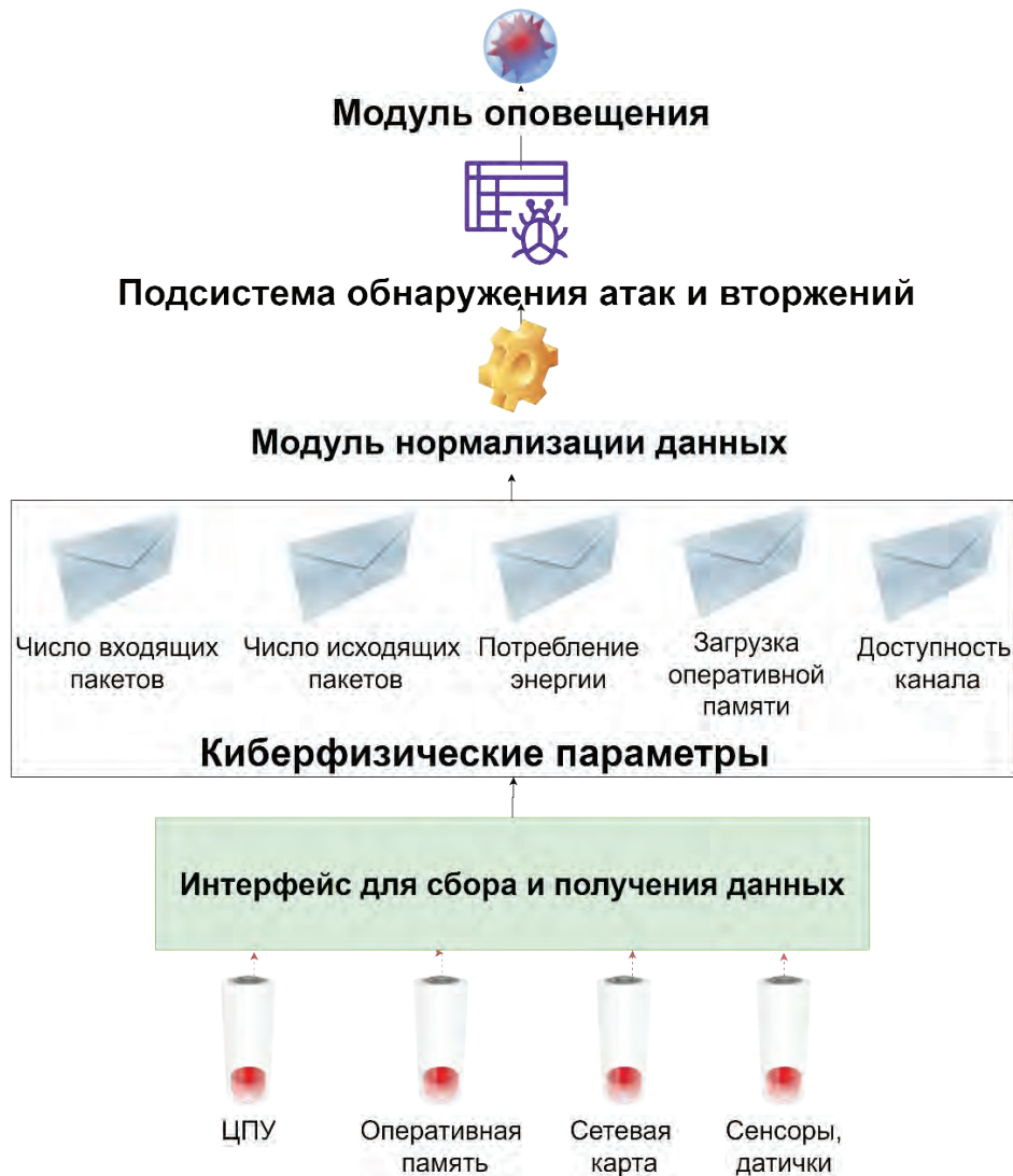
Рис. 1. Блок-схема системы адаптивной защиты сенсорного узла в киберфизической системе на примере БПЛА
