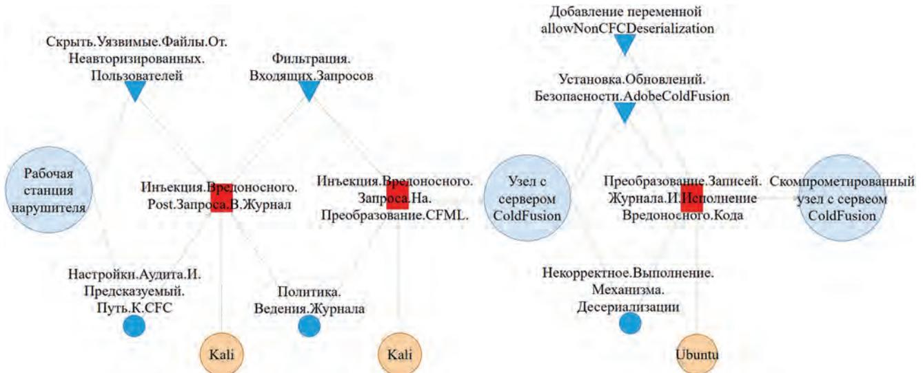
Рис. 1. – Формальное описание эксплуатации уязвимости с помощью методологии моделирования MAL
