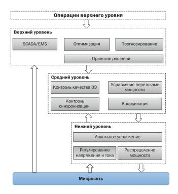
Рис. 1. Иерархическая схема управления сообществом микросетей
