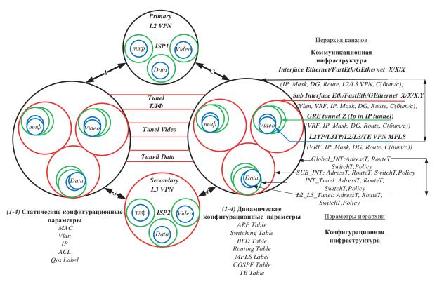
Рис.З. Вариант иерархической, вложенной коммуникационной инфраструктуры для моделирования распределенной инфраструктуры ИС, АСУТП, ИТС, объектов КИИ
