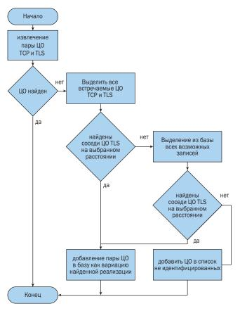
Рис.3. – Алгоритм автоматической классификации ЦО TLS-протокола
