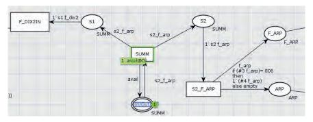
Рис. 13. Расщепление из единого потока S1, S2, кадров Ethernet с данными ( $F_DIX2$ ), кадров протокола ARP ( $f_arp$ ), пакетов протокола ARP ( $F_DIX2$ ,  $f_arp$  – запрос,  $f_arp$  – ответ) в структуры S1, S2
