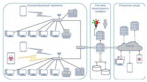
Рис. 1. Расположение систем поведенческого анализа сетевого трафика
