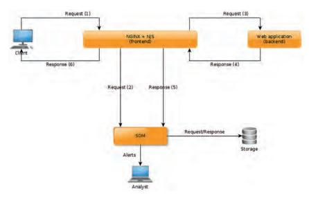
Рис. 1. Схема работы WAF, использующего нейронную сеть Кохонена
