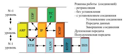
Рис.10. Вариант взаимодействия объектов различных уровней в соответствии с моделью OSI (7498), X.200, ГОСТ Р ИСО/МЭК 7498-1-99
