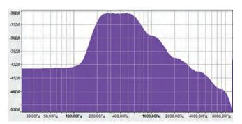
Рис. 2. Усредненная спектрограмма PC, зашумленного шумом со спектром, близким к нормированному спектру речи
