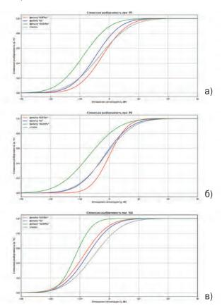
Рис. 5. Графики зависимости словесной разборчивости речи от SNR для исходной записи («эталон») и записей очищенными различными средствами шумоочистки (для средних значений) с помехами: шум со спектром, близким к нормированному спектру речи (а), «речевой хор» (б) и «уличный шум» (в) для средств шумопонижения: «GritTec's Noise Cancellation», «Sound Cleaner» и «Лазурь»
