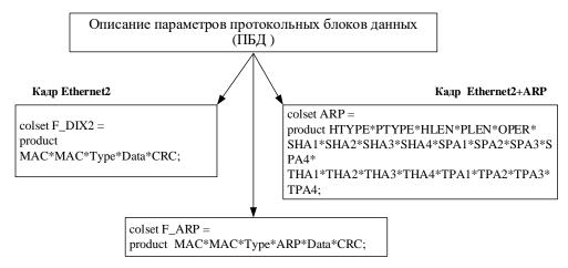
Рис. 11. Формирование иерархии цветов (типов) для кадра Ethernet, протокола ARP
