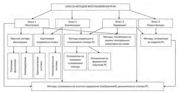
Рис. 1. Классы методов шумопонижения и реконструкции речи
