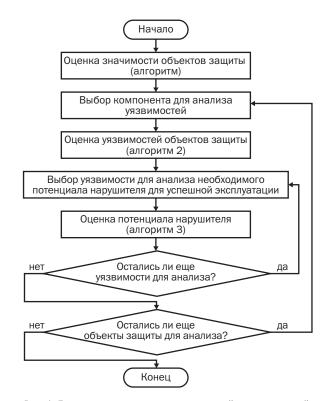
Рис. 1. Блок-схема процесса количественной и качественной оценки рисков ИБ АСУ ТП КИИ
