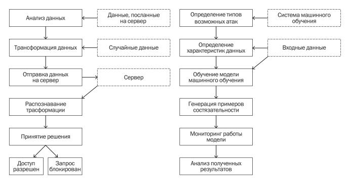
Рис. 4. Этапы метода защиты от предварительной обработки данных
