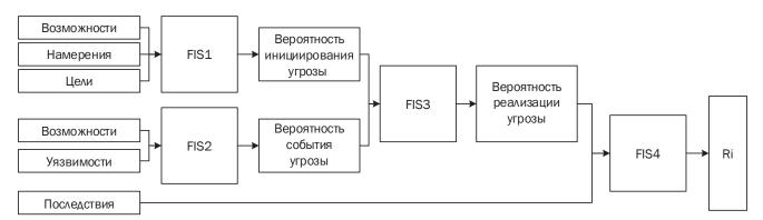
Рис. 4. Иерархическая нечеткая система оценки рисков кибербезопасности микросети
