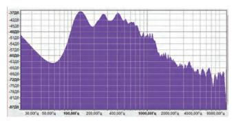
Рис. З. Усредненная спектрограмма РС, зашумленного помехой типа «речевой хор»
