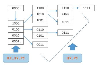
Рис. 3. Возможные состояния информационно-коммуникационной инфраструктуры ЭСО при кибератаках (ЦУ – централизованное управление, ДУ – децентрализованное управление, РУ – распределенное управление)
