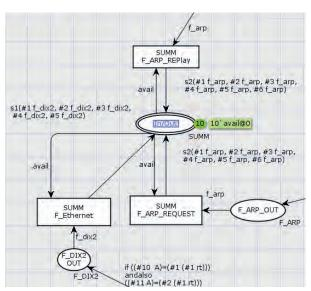
Рис. 12. Мультиплексирование объединение кадров с различным содержимым классов  $(F\_DIX2, f\_arp - запрос, f\_arp - ответ)$  в структуры S1, S2 для передачи в канал
