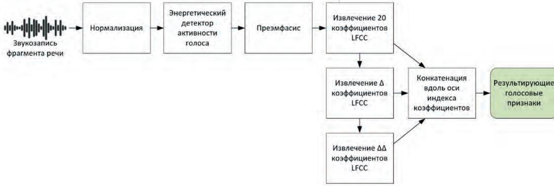
Рис. 1. Схема извлечения голосовых признаков
