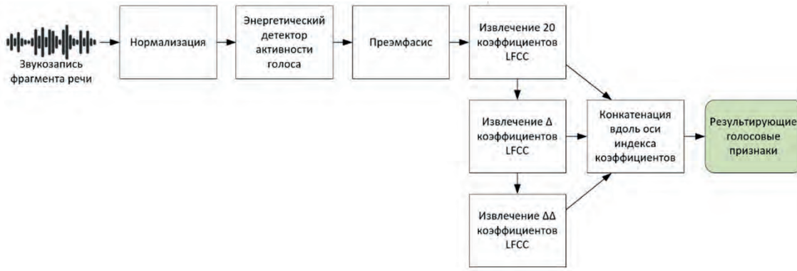
Рис. 1. Схема извлечения голосовых признаков
