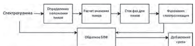
Рис. 6. Блок-схема алгоритма однопроходной инверсии спектрограмм с ОБПФ
