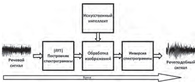
Рис. 1. Общая схема системы образного анализа-синтеза речи для технологии «звук-изображение-звук» при моделировании методов и средств ЗРИ в РМВ
