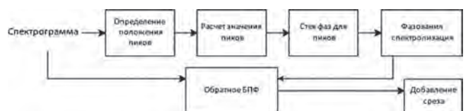
Рис. 6. Блок-схема алгоритма однопроходной инверсии спектрограмм с ОБПФ
