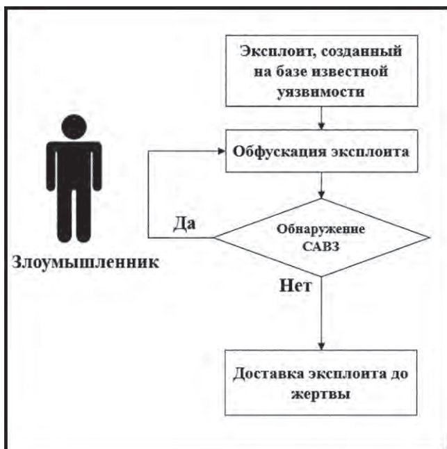
Рис. 1. Процесс подготовки эксплоита для обхода средств антивирусной защиты (САЗ)
