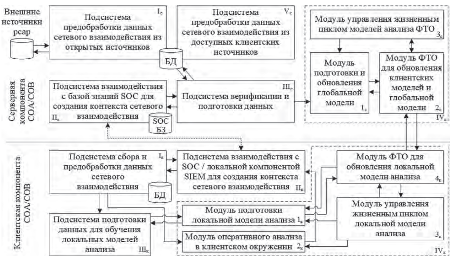
Рис. 4. Структурная схема клиентской и серверной компонент COA/SOB
