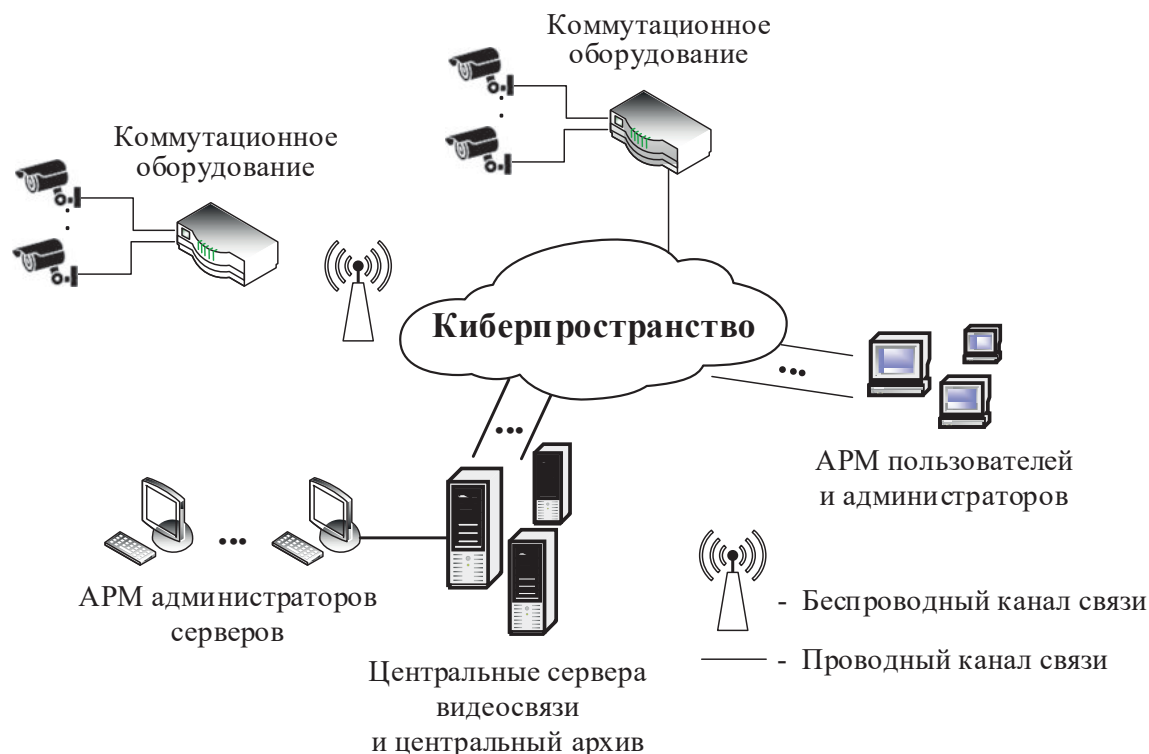
Рис. 2. Типовая структура территориально распределенной системы видеонаблюдения
