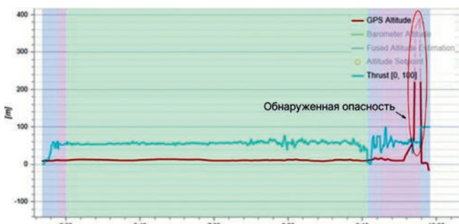
Рис. 1. Показания высоты полета БАС при проведенной атаке
