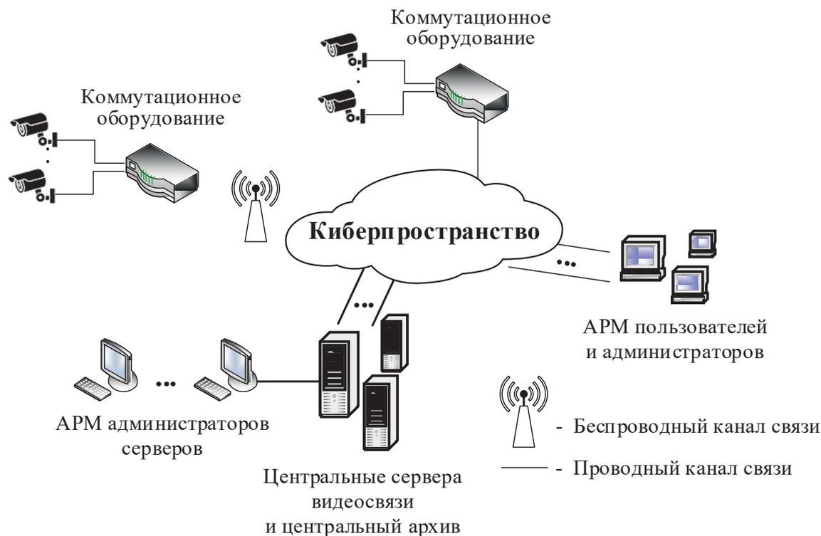
Рис. 2. Типовая структура территориально распределенной системы видеонаблюдения
