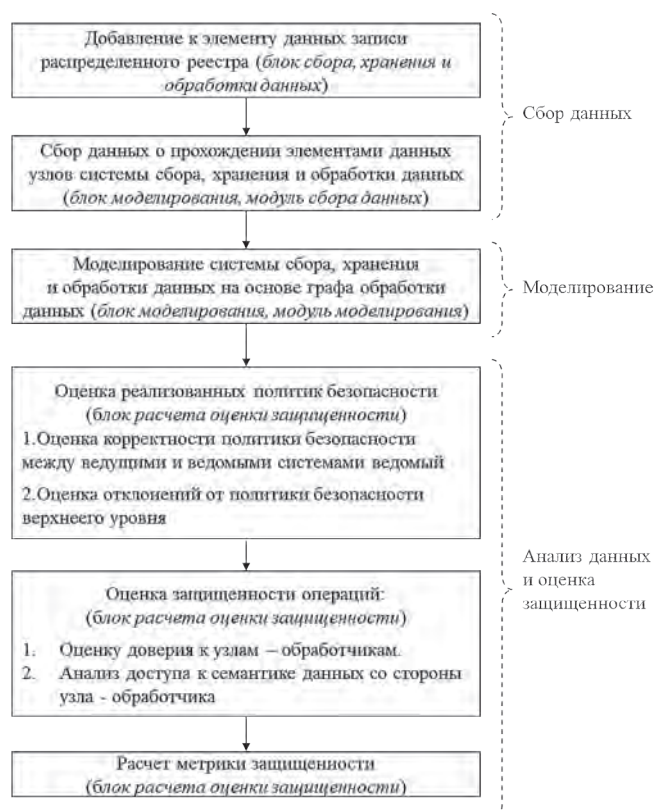
Рис. 2. Схема сбора данных и оценки защищенности в гетерогенных системах обработки и хранения больших данных
