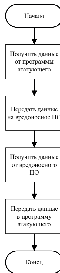
Рис. 5. Схема работы сервера между ПК атакующего и жертвы
